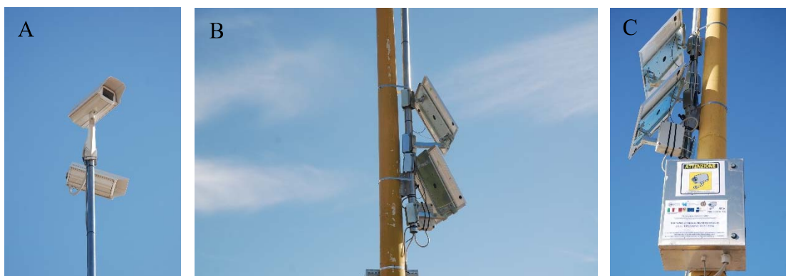
Figura 3: Particolari del Sistema di Video-Monitoraggio: A) il sistema di acquisizione; B) pannelli solari; C) unità di alimentazione e gestione del dato.
